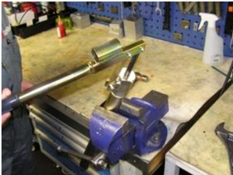
Kuva 4. Kierrä pumppu auki.
