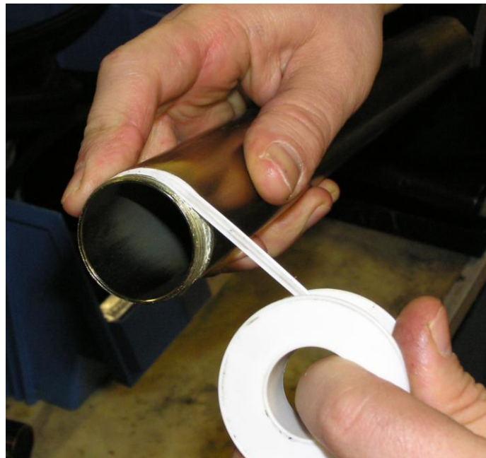
Kuva 12. Putkikierre teippi sylinteriputken päähän.
