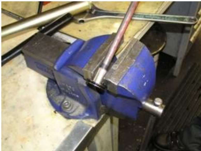
Kuva 6. Pumpun työmännän irroitus
