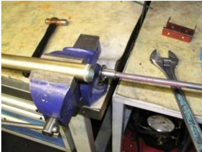
Kuva 5. Pumpun poisto sylinteristä.
