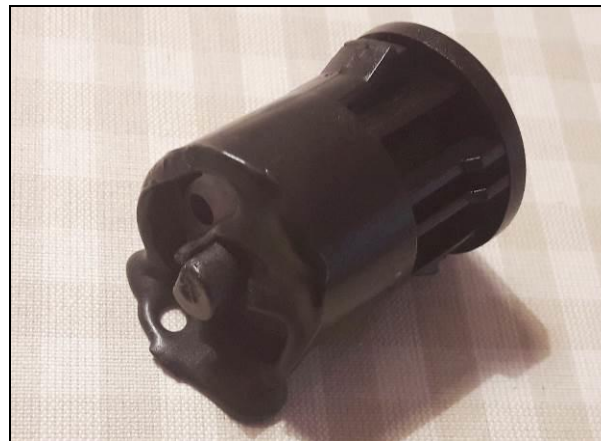
Kuva 22. Osittain sulanut virtalukko testin jälkeen.
