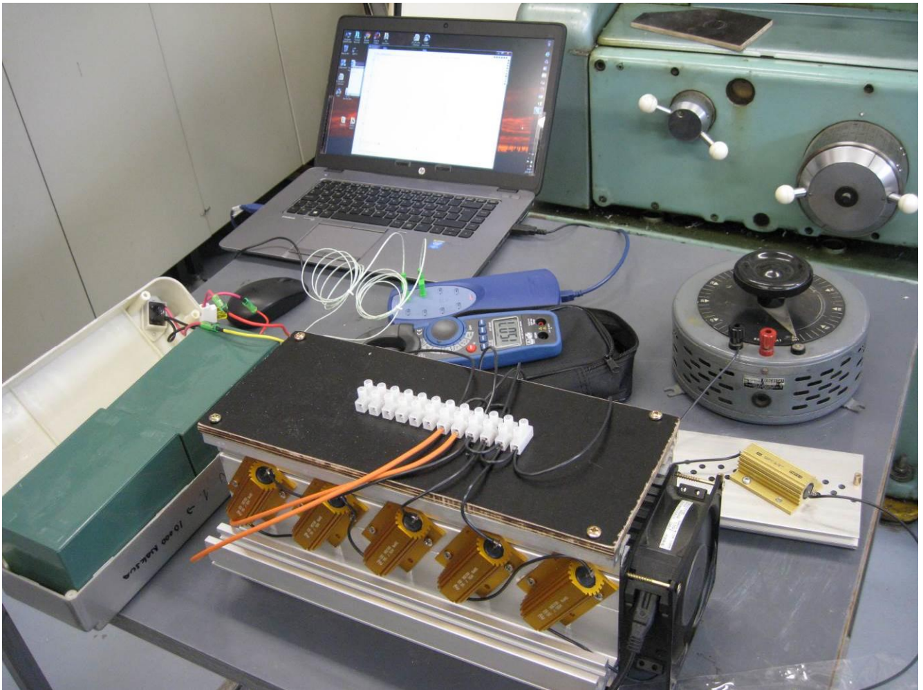
Kuva 1. Mittausjärjestely. Vastukset ja niiden säätölaite kuvassa etualalla ja oikealla.
