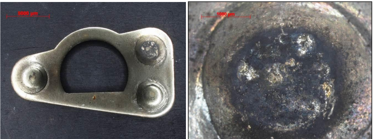
Kuva 6. Tutkimuksessa VTT-S-03842-16 testatun virtalukon toisena kytkentäpintana toimiva messinkinen vastakappale (vas.) ja lähikuva kontaktipinnasta (oik.). Lähikuvassa oleva kontaktipinta sijaitsee vastakappaleessa (vas.) oikealla ylhäällä.
