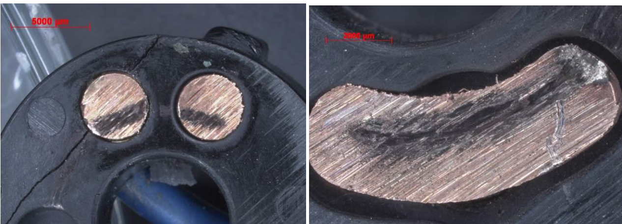
Kuva 8. Lähikuvia kuparinastojen pinnoista virtalukossa, jota on käännetty 10 000 kertaa edestakaisin. Virtalukon pohja on murtunut irrotettaessa (vas.).
