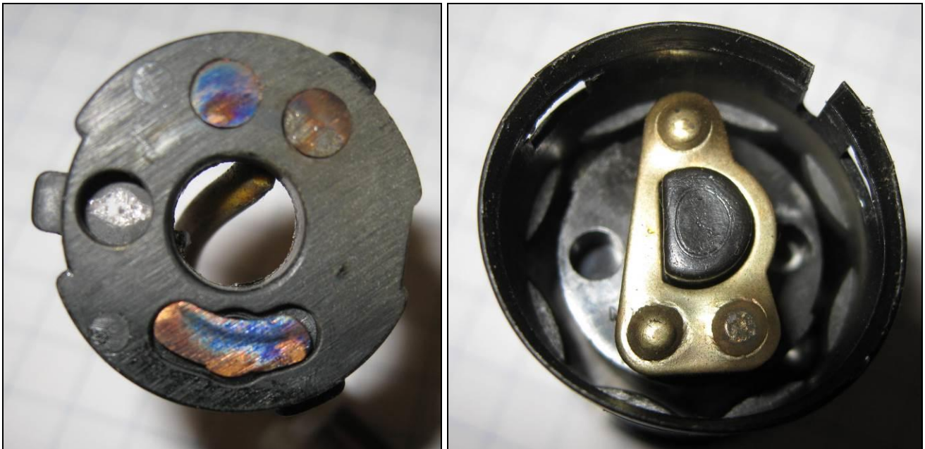
Kuva 4. Tutkimuksessa VTT-S-03842-16 testatun virtalukon pohjan kontaktipinnat.
