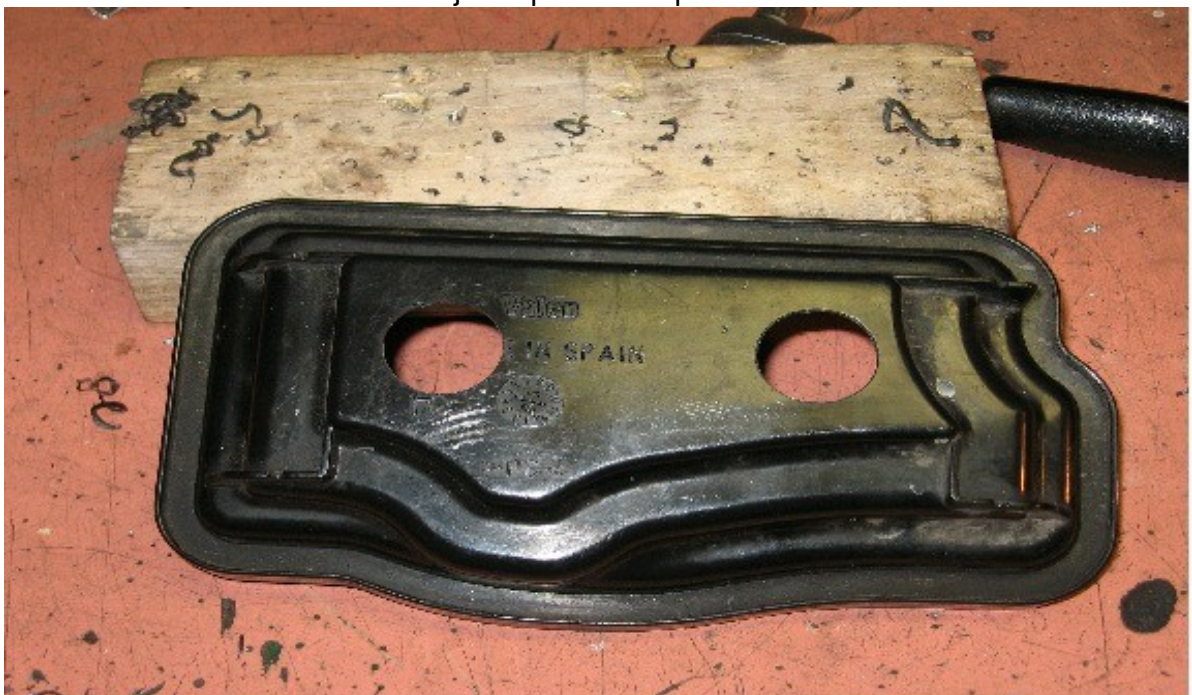
Kuva.3 Johtojen läpivientien poraukset.
