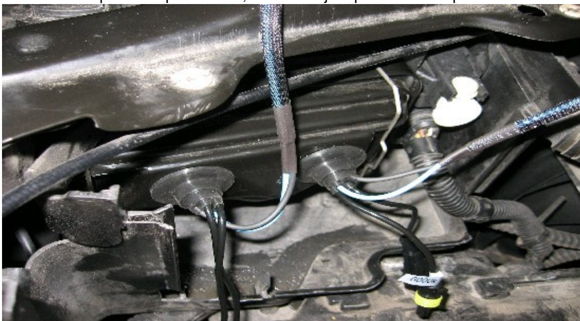
Kuva 5. Xenonpolttimet paikoillaan, takakansi ja läpivientikumin paikoillaan.
